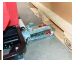
ErgoPack vor die Palette rollen, Kettenlanze...
