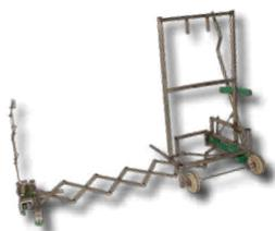
Erster Prototyp eines Umreifungsapparates basierend auf einem Doppel-Scherensystem ähnlich eines Scherenhubtisches.
