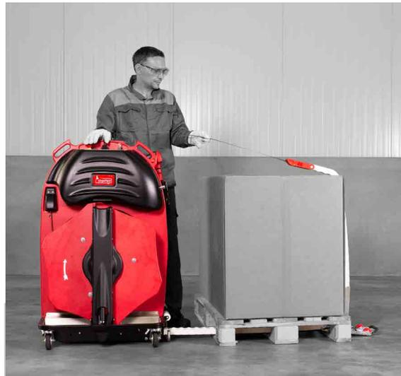
Auf der Rückseite wieder hoch, zurück in die Hand des Anwenders. Die **Kettenlanze** fährt wieder ein. Der **Bandheber** hebt das zweite Bandende.
