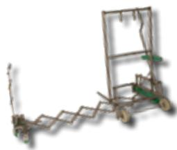
Erster Prototyp eines Umreifungsapparates basierend auf einem Doppel-Scherensystem ähnlich eines Scherenhubtisches.
