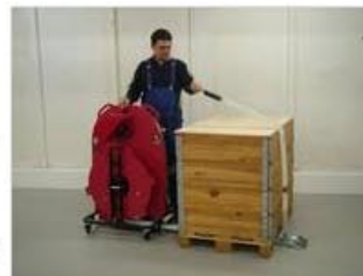
Mit ErgoPack können Paletten ohne Bücken und ohne um die Palette laufen zu müssen von einer Seite bequem im Stehen umreift werden. Bild: ErgoPack
